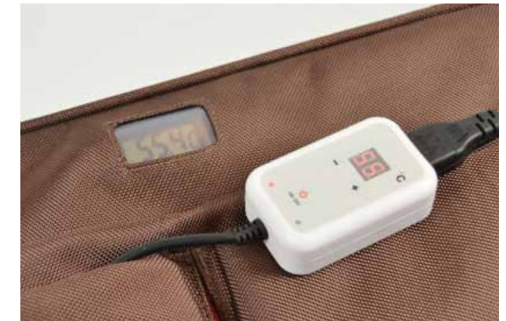
Tjek temperatur displayet og når det når en god arbejdstemperatur, sænk temperaturen på kontrolleren så de matcher
